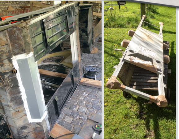
Metallarbeits für Profis: Die Rostlöcher der Fahrgastzelle – buchstäblich bodenlos – hilft ein befreundeter Blechprofi zu schließen. Der durchgerostete Rahmen wird ausgetauscht
