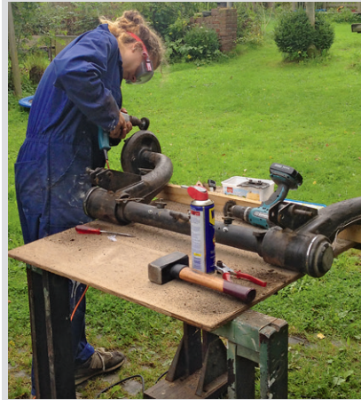
Schleifen, Bürsten, Entrosten: Wohl nichts hat Paula in den acht Monaten intensiver Arbeit ausführlicher betrieben
